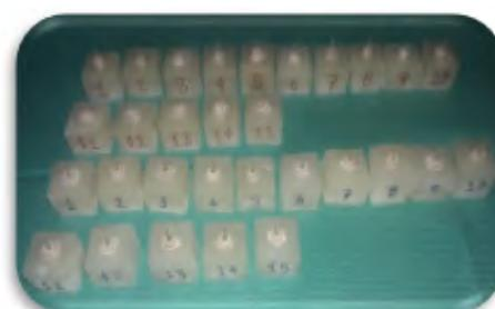
Figura N° 12,13 La realización de la prueba de tracción fue ejecutada por medio de una Máquina CBR digital en el cual se procedió a colocar las muestras en la maquina sujetándolo en un extremo por el poste de fibra de vidrio y por el otro extremo por el cubo de acrílico
