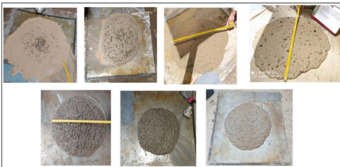
Figura 1: Consistencia y cohesividad de las mezclas de prueba de menos estable a estable (izquierda a derecha)
