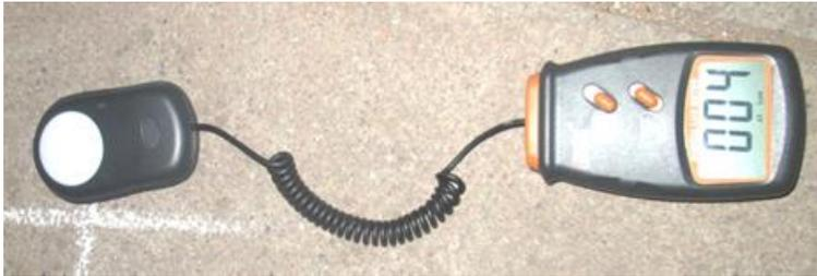
**Figura Nro. 2: Instrumento Luxómetro utilizado en la medición**
